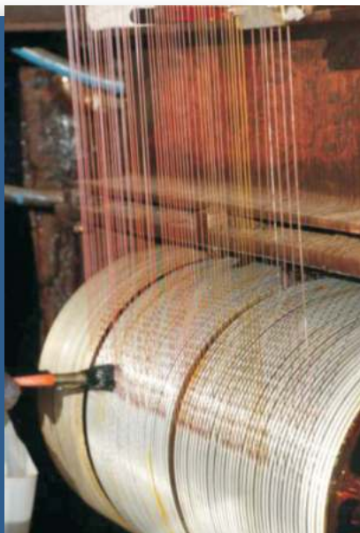
Proceso de esmaltado en alambre magneto
